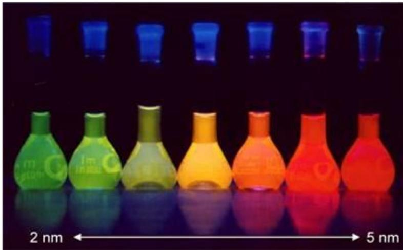
Частота испускаемого света уменьшается с увеличением размеров частиц
