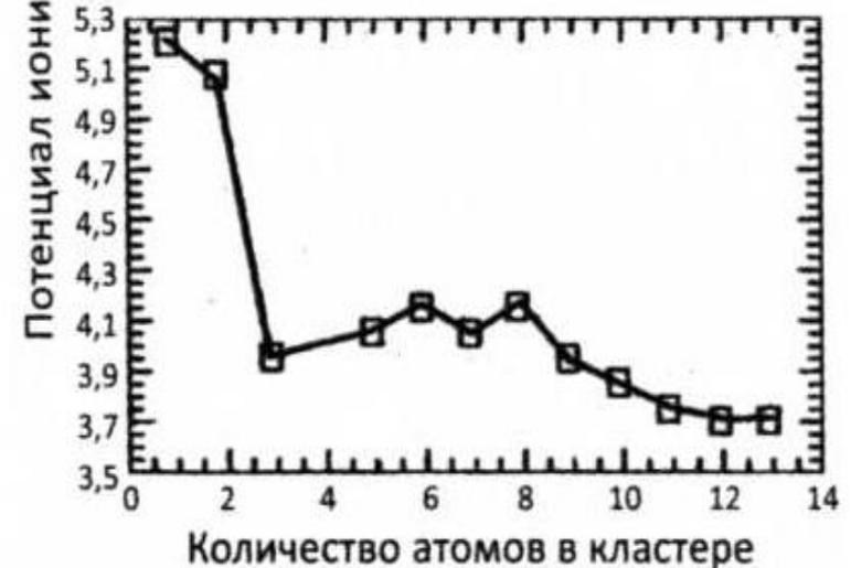
Зависимость энергии ионизации отдельных атомов от атомного номера и зависимость энергии ионизации **кластеров натрия от числа атомов в кластере.**
