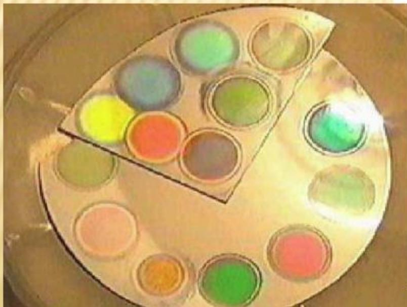
← Образцы наноструктурированного кремния
